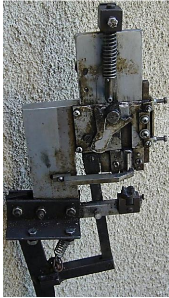
Рис. 5. Щеплювальна машинка заводу «Полігон» (розробка ННЦ «ІВіВ ім. В.С. Таїрова»)
