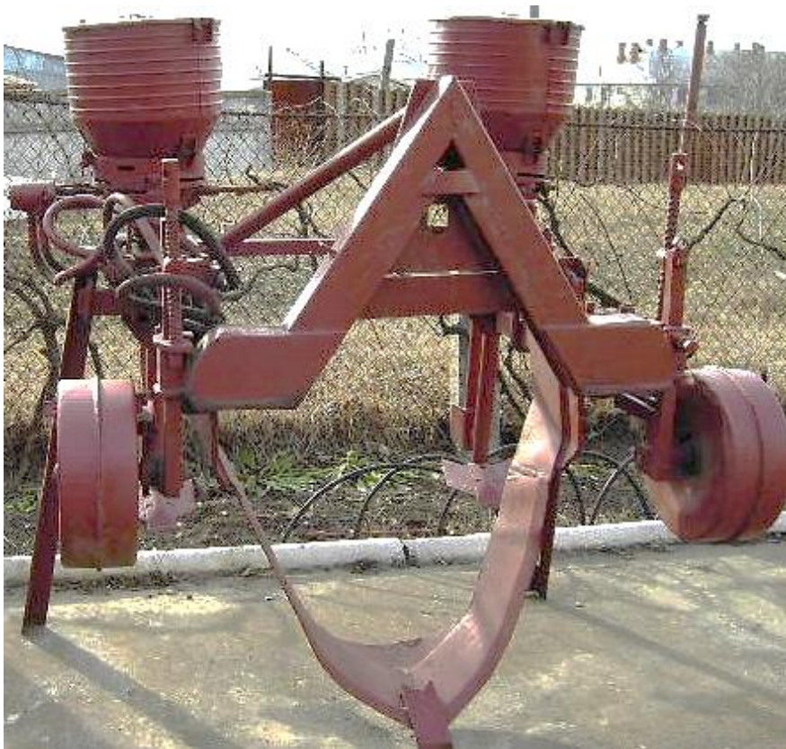
Рис. 2. Глибкорозпушувач РВ-3, обладнаний тукоподаючою системою
