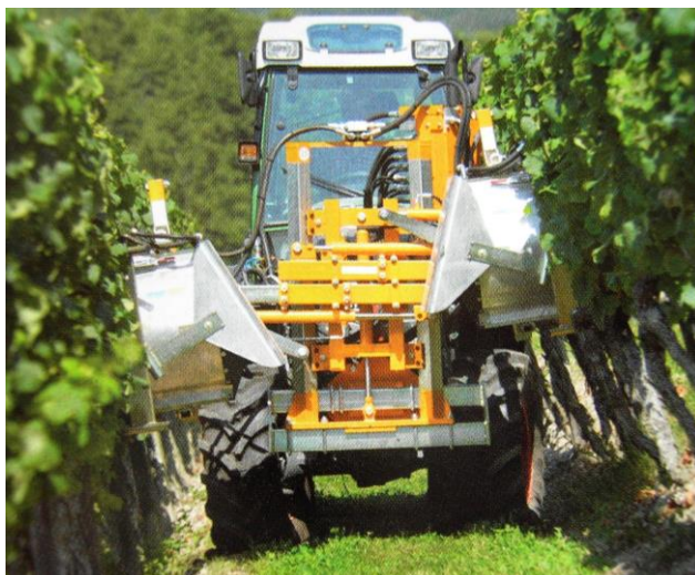
Рис. 4. Механізоване видалення листя в зоні розташування грон винограду
