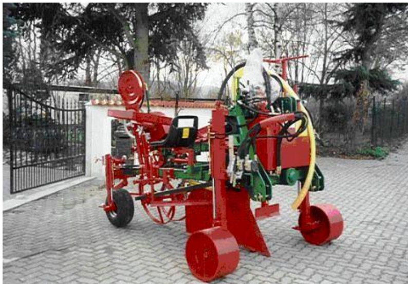
Рис. 2. Машина для механізованого садіння виноградних саджанців з використанням навігаційних систем.
