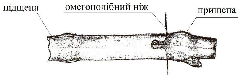
Рис. 3. Схема омега-подібного з'єднання прищепи і підщепи винограду
